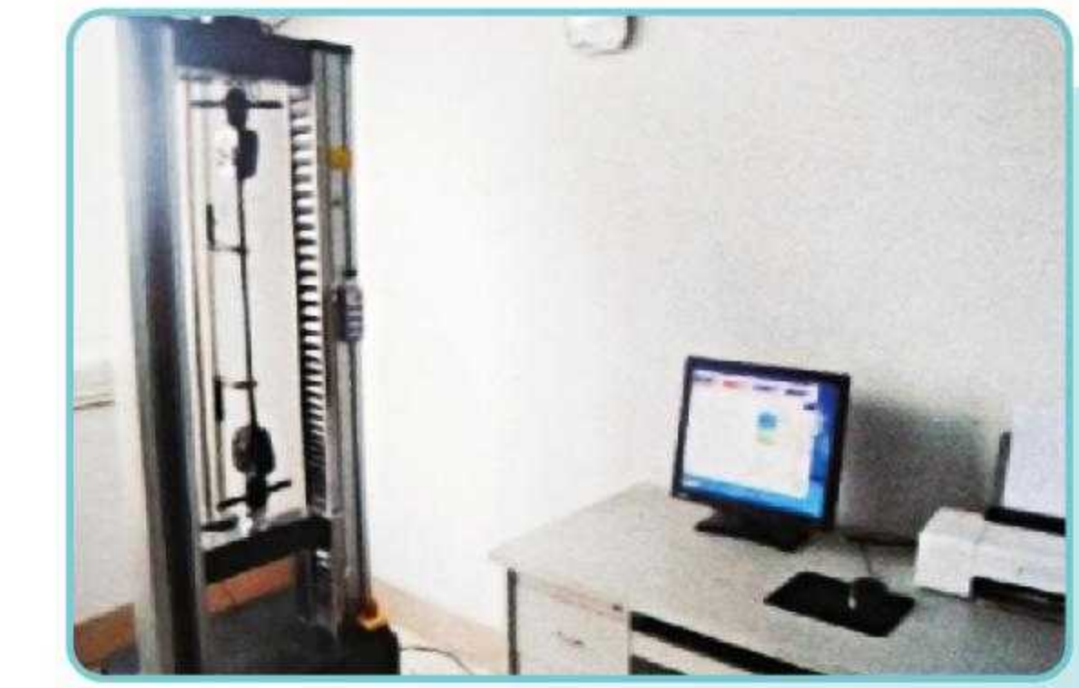
万能试验机 Universal testing machine
